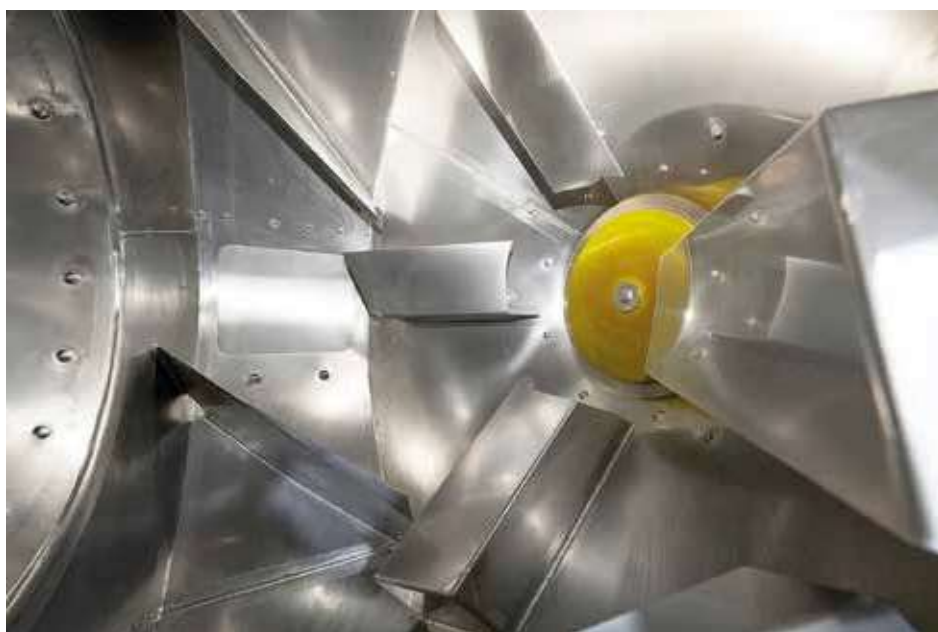
Les ailettes de mélange garantissent un mélange uniforme en près de 5 minutes.
