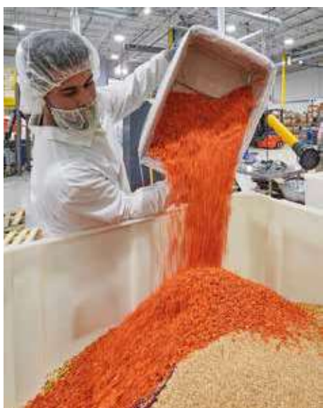
Les ingrédients sont vidés dans une trémie de 0,56 m 3 qui est placée en entrée du mélangeur.
